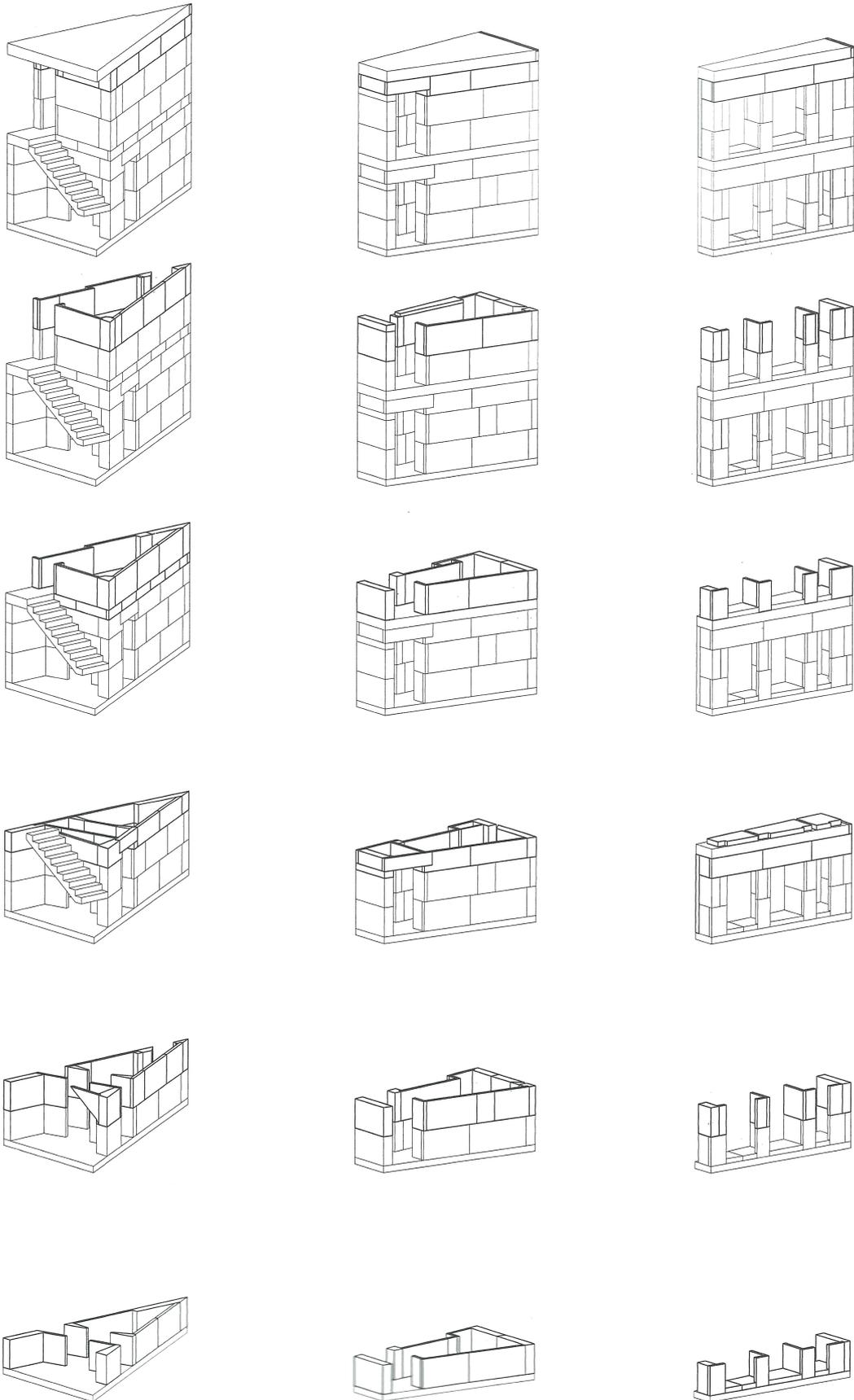
AXONOMÉTRIE ASSEMBLAGES BLOCS SERVANTS
